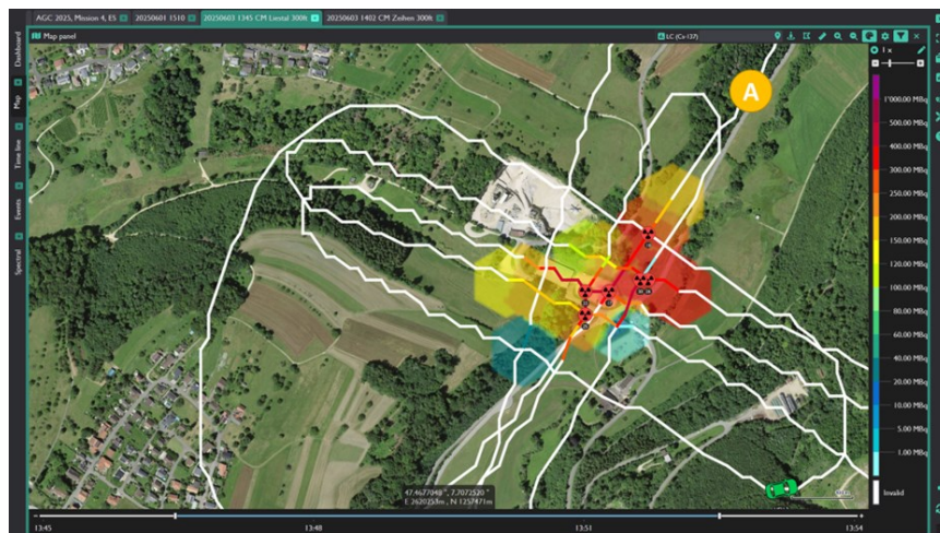
Figure 13 : Mission 3 – identification des sources au sud-ouest de Liestal. Capture d'écran du logiciel de mesure après plusieurs survols de l'emplacement des sources.
