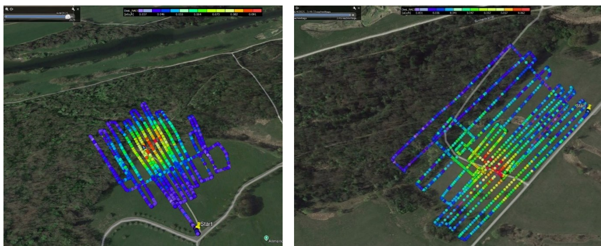
Figure 23 : Mission 4 – recherche de sources avec drones. Cartes du DDA des deux périmètres définis pour les drones établies par le Laboratoire de Spiez (CHE).
